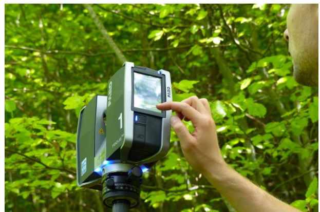
Abb. 4, 5 und 6 LiDAR-Messungen ob Maienfeld (GR): Jede Probestfläche, die 5 Scannerpositionen und alle Positionen der Targets (Kugeln) werden im Pilotprojekt Schutzwald exakt vermessen – ein derzeit noch zeitraubendes Unterfangen (Bilder Urs-Beat Brändli).
