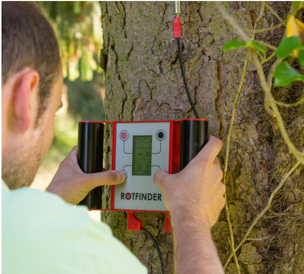
Abb. 3 Mit dem Rotfinder soll im LFI5 pro Probestfläche eine Fichte auf Rotfäule untersucht werden. Pro Baum beträgt der Zeitaufwand 6 Minuten. Gemessen wird der elektrische Widerstand (four-point resistivity method), wobei 4 Elektroden nur etwa 1 cm tief in den Baum gedrückt werden. Mehrere Studien haben gezeigt, dass mit dem kaum 2 kg schweren Rotfinder eine vergleichsweise gute Detektionssicherheit von Kernfäulen an Fichte möglich ist (Bild Simon Speich)
